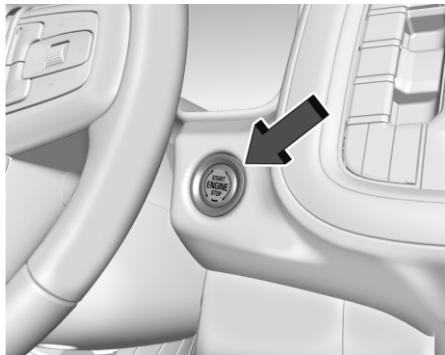
Автомобили, оснащенные системой дистанционной идентификации ключей, запускаются нажатием кнопки.
