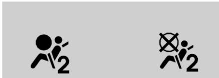
При запуске автомобиля в ходе проверки системы индикатор состояния подушки безопасности пассажира попеременно включает на несколько секунд символы включенной и отключенной подушки.
