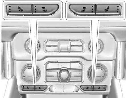
Кнопки (в соответствующей комплектации) находятся рядом с регуляторами системы климат-контроля на центральной стойке. Подогрев сидений работает только при включенном двигателе.
