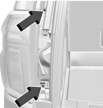
4. Снимите два винта заднего фонаря.
