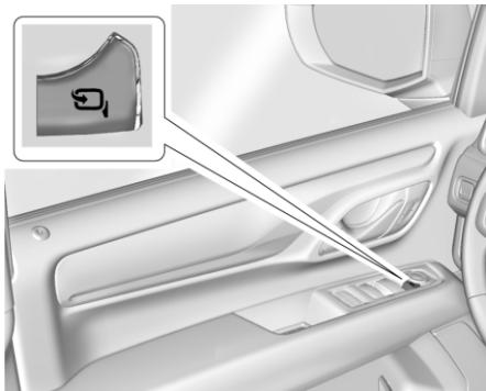
Регулировка зеркал с электроприводом, если предусмотрены:
