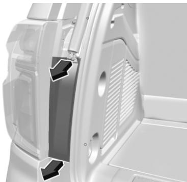
3. Снимите с заднего фонаря нижнюю прилегающую крышку, потянув ее вниз за верхнюю и нижнюю части, чтобы освободить защелки.
