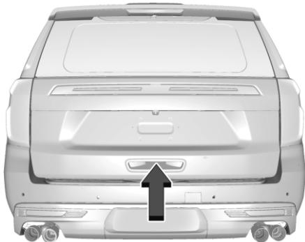
Чтобы открыть дверь багажного отделения, нажмите на кнопку на выключателе электрического запирания двери или дважды нажмите на кнопку на радиобрелоке, чтобы отпереть все двери. Нажмите на сенсорную панель (1) на нижней стороне ручке задней откидной двери и поднимите дверь.
