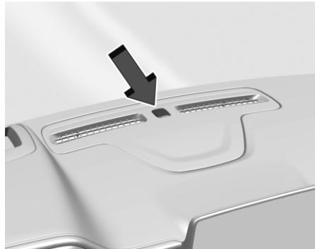
На верхней части панели приборов установлен датчик освещенности. Не накрывайте ничем датчик, иначе фары будут включаться даже тогда, когда этого не требуется.
