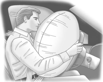
Передняя подушка безопасности на стороне водителя находится в центральной части рулевого колеса.
