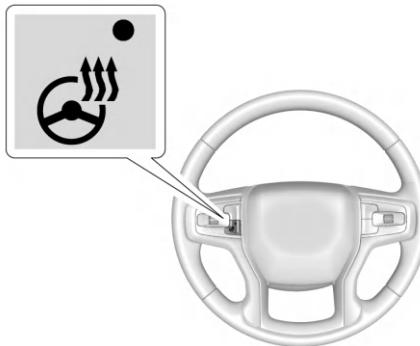
: Нажмите, чтобы включить или выключить подогрев рулевого колеса, если он есть. Индикатор рядом с кнопкой светится, когда подогрев включен.
