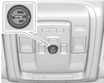
Если автомобиль оснащен прозрачным люком крыши с электроприводом, то переключатель управления люком находится на верхней консоли. Автомобиль должен быть в режиме P (стоянка).
