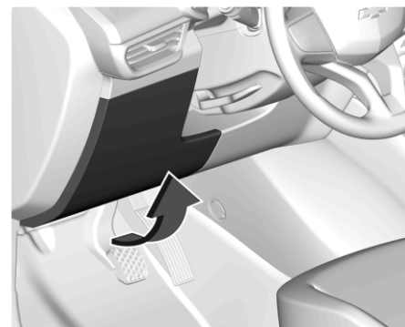
Блок предохранителей в приборной панели
